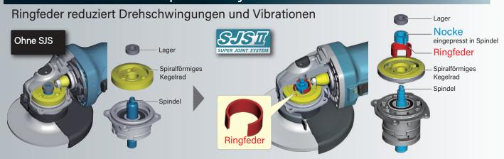
So funktioniert das Super Joint System II
