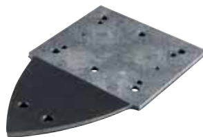
191Y22-2 Modell: DBO480, DBO484. Die Grundplatte eignet sich durch die vordere Spitze der Deltaschleifer hervorragend für Arbeiten an Innenecken oder schwer zu erreichenden Stellen. Die Schwingschleifplatte rundet den Einsatz an größeren Werkstücken ab. Passend für Schwingschleifpapier 114x102 mm und allen gängigen Deltaschleifpapieren mit Klettvorrichtung. Klett
