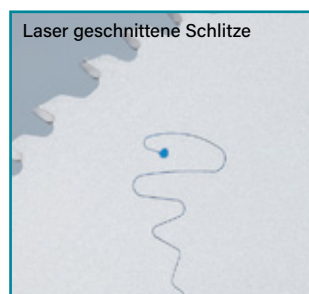
Lasergeschnittene mit Kunstharz gefüllte Schlitzte vermindern Vibrationen und Geräusche
