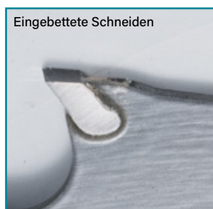
Eingebettet Schneiden verhindern das Ausbrechen der Zähne bei z.B. Nagelrückständen im Werkstück
